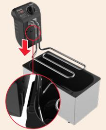
■ Bei Überhitzung stoppt die Fritteuse automatisch dank des Thermoschutzes. Zum Neustarten den «Restart»-Knopf auf der Rückseite des Thermostats mit einem spitzen Gegenstand (z.B. Kugelschreiber) drücken. Vorher Gerät vom Strom trennen und abkühlen lassen.
