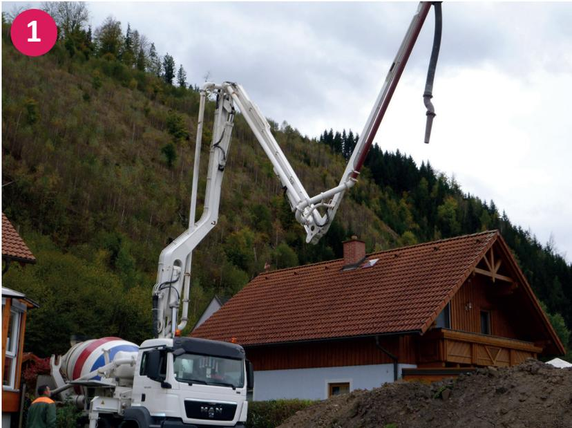
▲ Betonwagen mit Betonpumpe und Fallbremse
